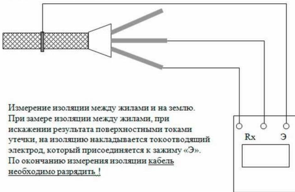
Рис. 4 – Измерение сопротивления изоляции мегомметром
